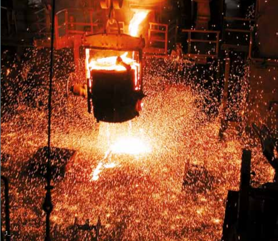
1_ Flüssiges Metall wird aus einem Elektrolichtbogenofen abgegossen.
